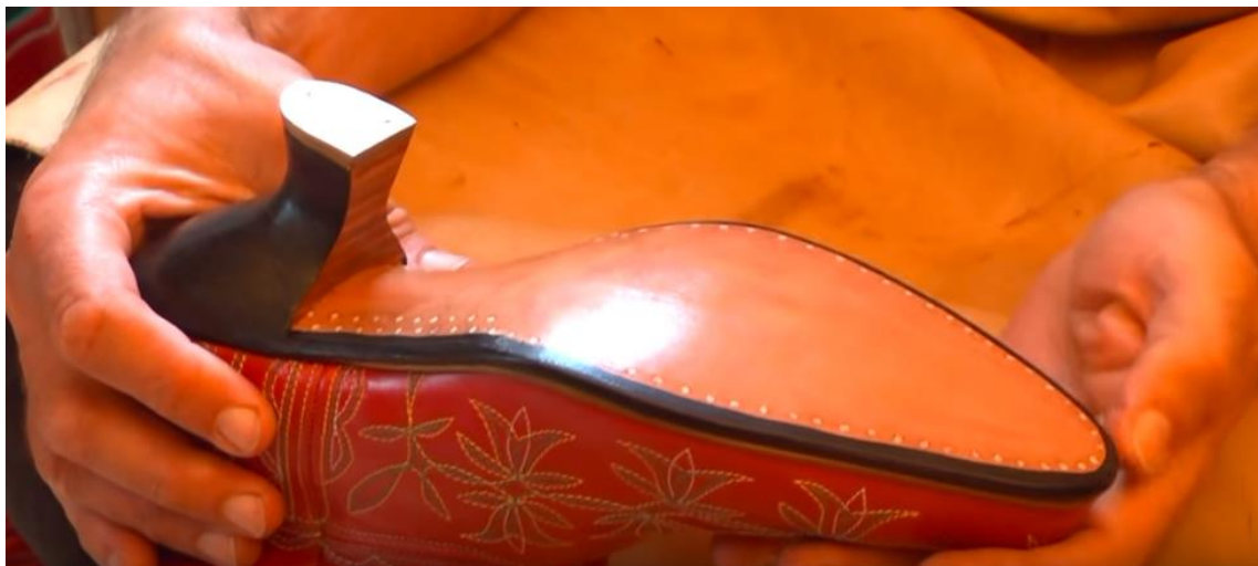
93. ábra: Faszeges – rakott borsarkas aljakialakítás 93
