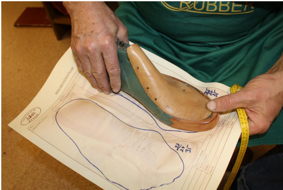
11. ábra: Kaptafa méretre alakítása 11
