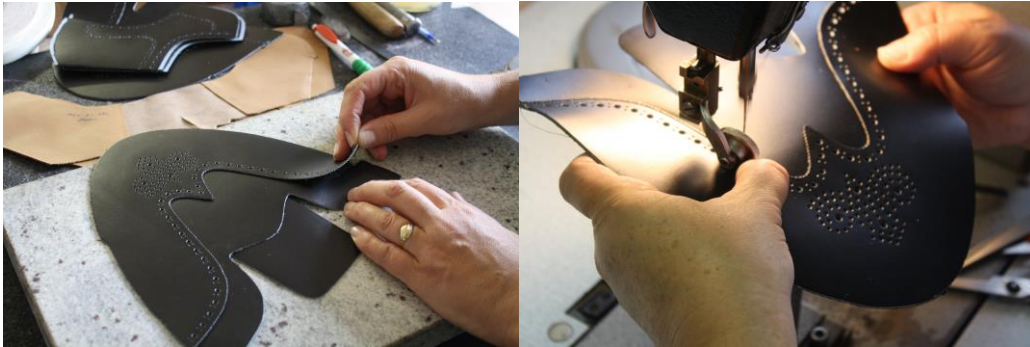
83. ábra: Fejrész összeállítása, tűzése 83
