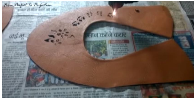
66. ábra: szerszám nélküli számítógép vezérelt lyukasztás, robottechnika 66
