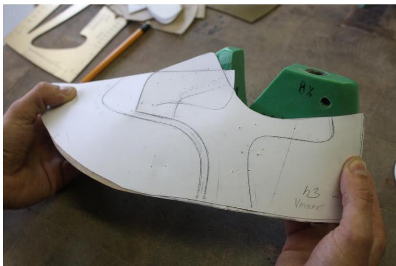
15. ábra: Alapminta ellenőrzése 15
