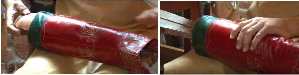
98. ábra: Felsőrész sámfázása (2-3) 98
