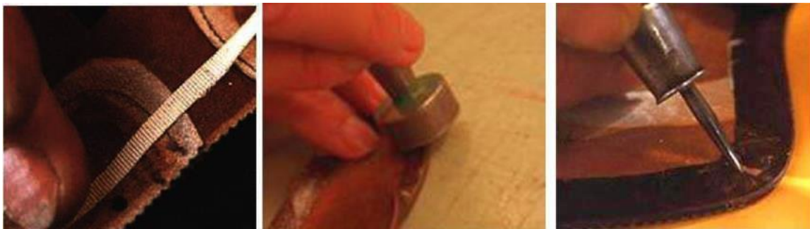
54. ábra: Kézi szélbehajtás, kierősítő szalag felvezetése, kalapálás, ráncok beszedése 54
