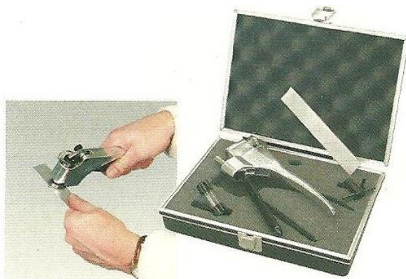
2.2.1. ábra: Webster típusú keménységmérő fogó 0,6 – 8 mm anyagvastagsághoz. Rockwell keménységmérés táblázat használatával
