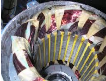
5. ábra Tekercsfej rögzítése 3
