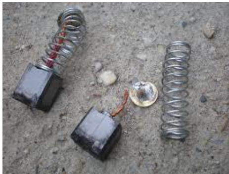
9. ábra Túlterhelődött, kopott szénkefék 7
