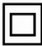
117. ábra Érintésvédelmi osztályok jelölése
