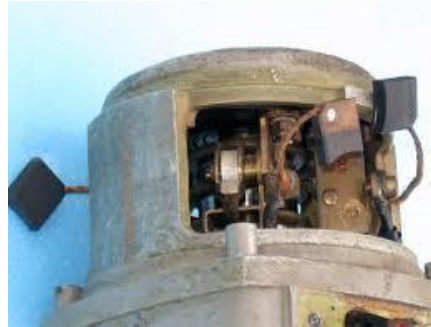
8. ábra Kiemelt kefék a kefetartóból 6
