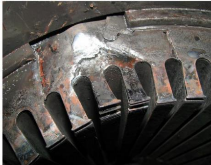
3. ábra Állórész lemezelési hiba 1
