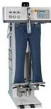
68. ábra Nadrágvasaló berendezés
