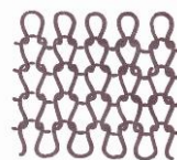
Vetülékrendszerű sima egyszínoldalas kötés színoldala
