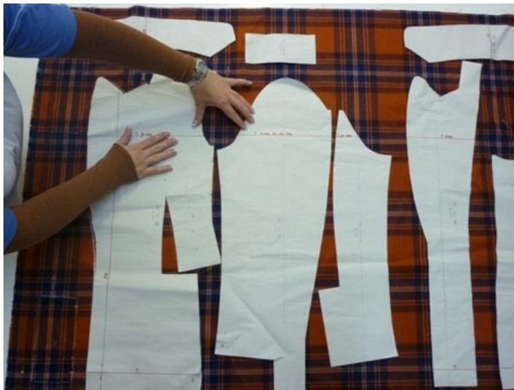
57. ábra Kockás anyagra felfektetés készítése (tengelyezés)
