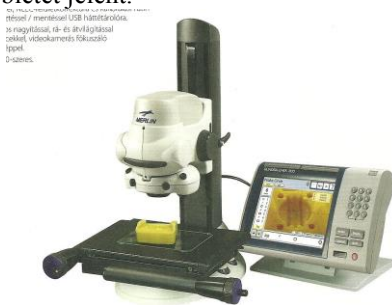
2.3.1. ábra: Merlin tip. 2 tengelyes mérőmikroszkóp
