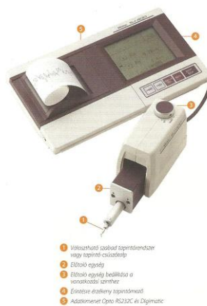
2.3.5. ábra: Felületi érdességmérő műszer Mitutoyo SJ 401 tip.
