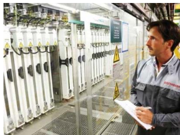
60. számú ábra: Szeparáló aktív és passzív modulok potenciálfallal (rendkívül energiatakarékos rendszer) (forrás: VW Pozsony)
