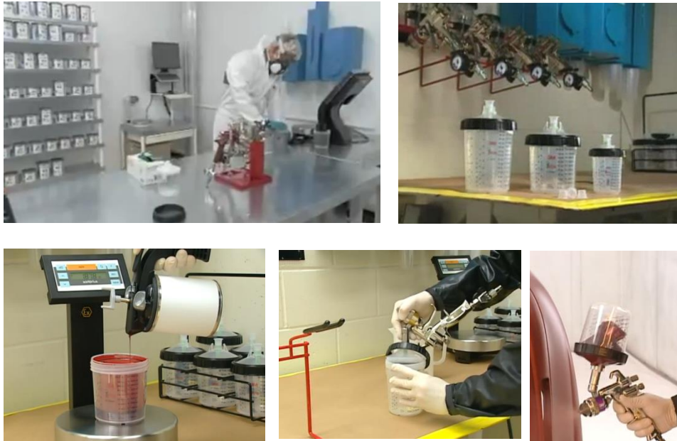
92-93. számú ábra 3M™ PPST™ Festékkeverő és adagoló rendszer bemutatása mozaikokban
