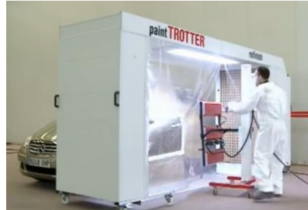
87. számú ábra Mobil infravörös sugárzásos rövid- hullámmal szárító Infra Quick rendszer (forrás: Kövesdi Kft.)
