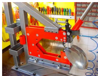
22. ábra- nyújtó- zömítő berendezés
