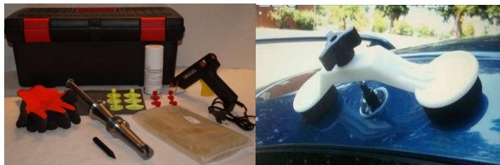
71. ábra- a ragasztásos horpadások egyengetésének szerszámai és technológiája
