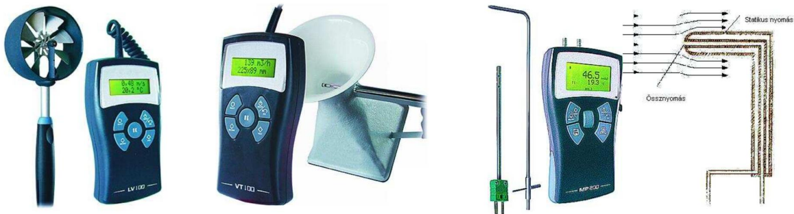
30. ábra 65 Szárnykerekű anemométer (szélsebességmérő), hődrótos anemométer, Pitot-cső, Prandtl cső.
