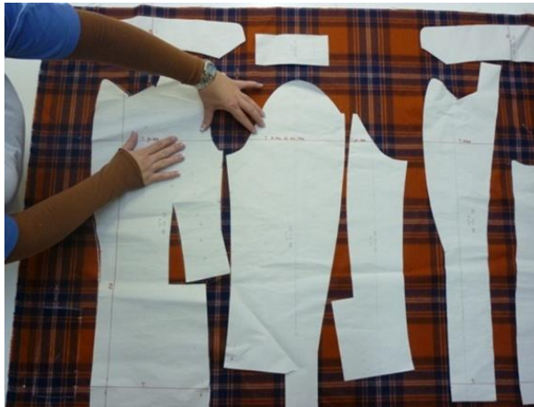
57. ábra Kockás anyagra felfektetés készítése (tengelyezés)
