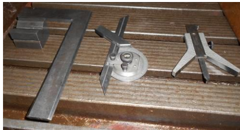
3.4.1. 2. Fotó: derékszög, mechanikai szögmérő
