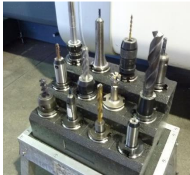
1.4. 3. fotó CNC megmunkálóközpont szerszámai, szerszámbefogói 34
