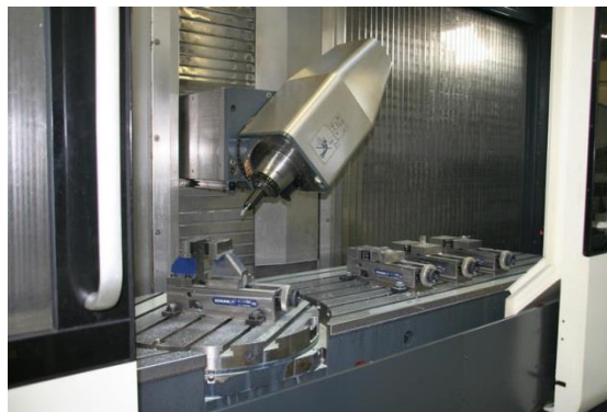
1.4. 2. fotó Deckel Maho DMF 260 típusú 5 tengelyes megmunkáló központ munkatere billenthető főorsóval és forgóasztallal 33
