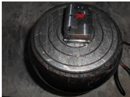
2.5.2. 3. Fotó Lézer felrakó hegesztéssel kivitelezett varrat szerszám alkatrésze 73
