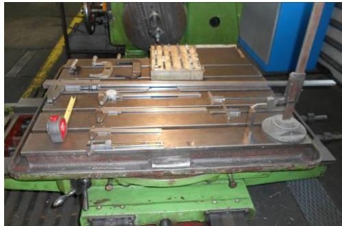
2.4.1. 1. Fotó: mérőszalag, mechanikus tolómérők, mérőhasáb készlet
