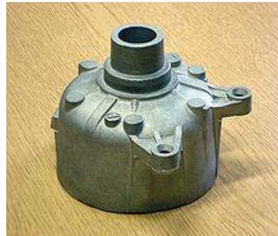
2.1.2. ábra. Nyomásos öntéssel készült alkatrész 47
