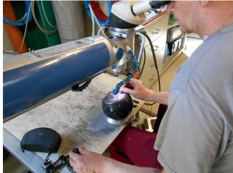
2.5.2. 2. Fotó Lézer felrakó hegesztés kivitelezése 72
