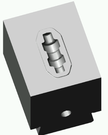
2.1.7. ábra. Együregű süllyesztékszerszám 50
