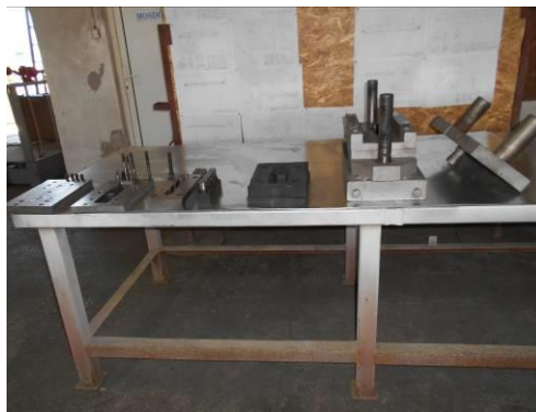
2.5.1. 4. fotó Kivágó szerszám elemeire szerelve
