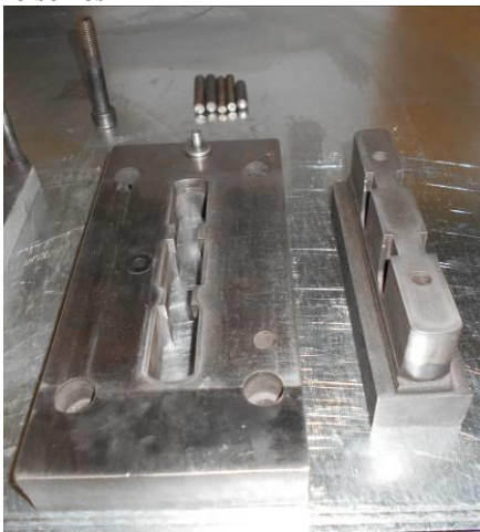
2.5.1. 3. fotó Vágólap, vágóbélyeg kiserelve
