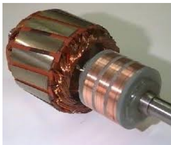
108. ábra. A tekercselt szinkron motor forgórésze 79
