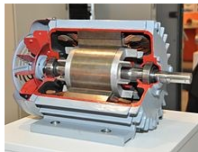
108. ábra. A tekercselt szinkron motor forgórésze 79
