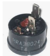
Áramrelé (amikor a motoráram induláskor kicsi, az érintkezői zárva vannak, amikor nagy az érintkezői nyitnak.)
