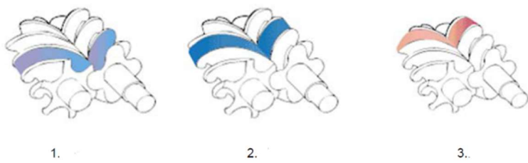
Csavarkompresszor surítési fázisai (1-3)
