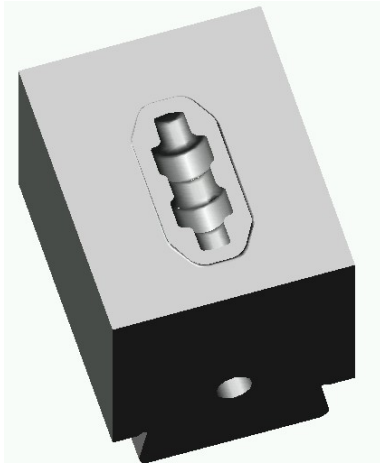
2.1.7. ábra. Együregű süllyesztékszerszám 50
