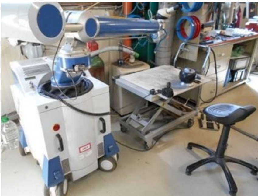
2.5.2. 1 Fotó Lézer hegesztőgép, lézerhegesztő munkahely, huzal, munkaasztal munkadarab forgatóval
