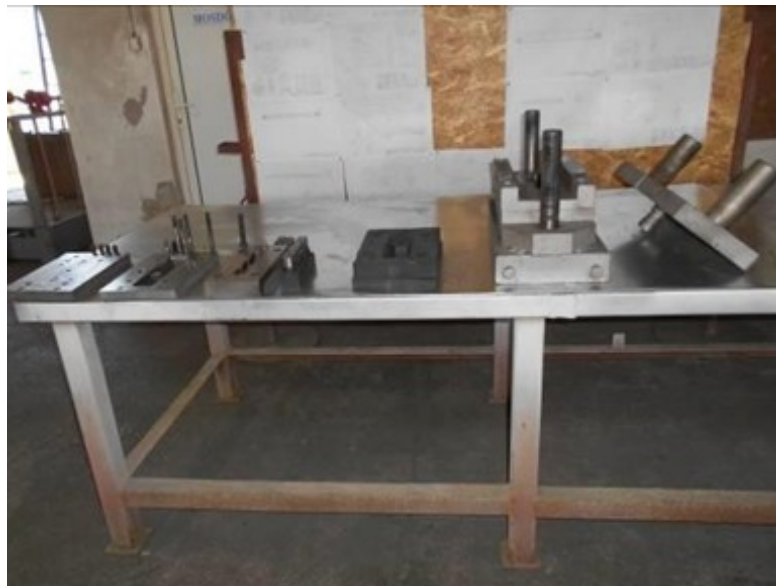
2.5.1. 4. fotó Kivágó szerszám elemeire szerelve
