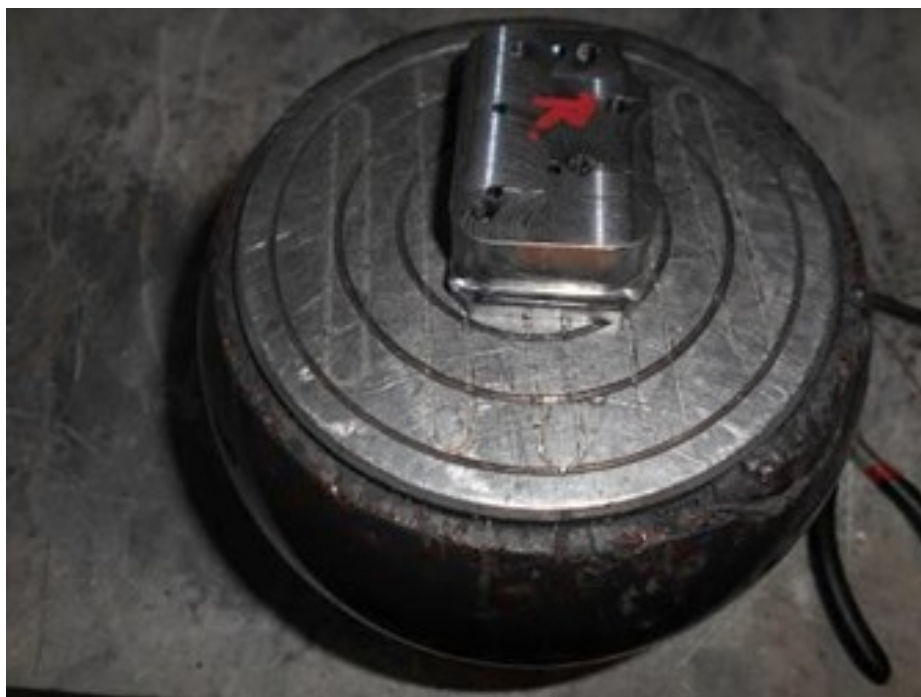
2.5.2. 3. Fotó Lézer felrakó hegesztéssel kivitelezett varrat
