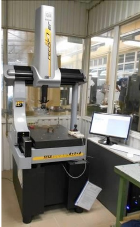
2.4.2. 4. Fotó: vezetérendszer állványhoz, konzolhoz légsapágyazással
