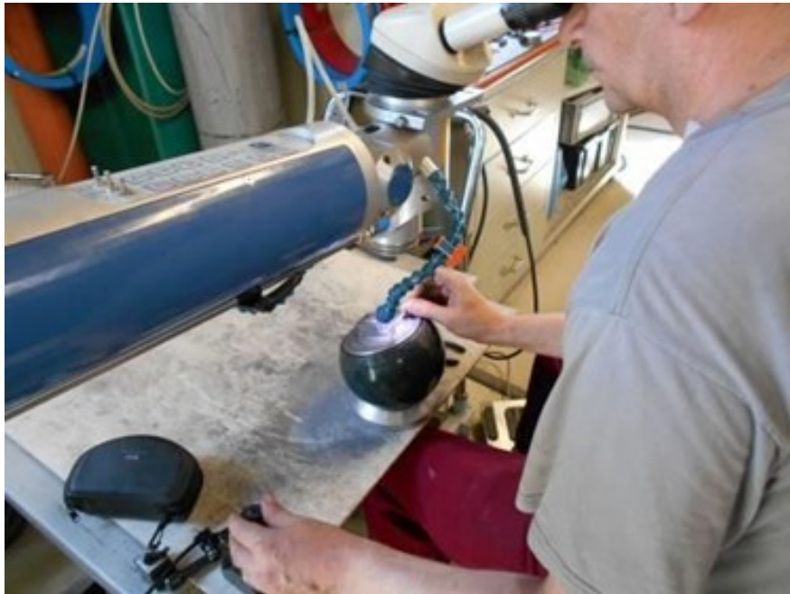
2.5.2. 2. Fotó Lézer felrakó hegesztés kivitelezése
