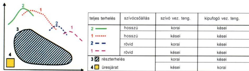
74. ábra. A harmadik generációs vezértengely-állító működése 77
