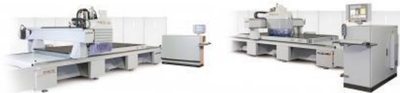
8.12. ábra: CNC megmunkáló központ gépsorrá alakítva 114
