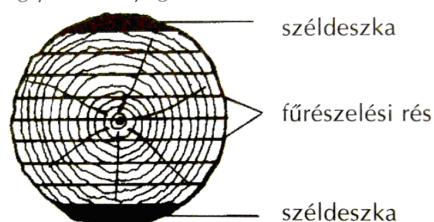
11.104. ábra: Horizontális (vízszintes) éles vágás 196
