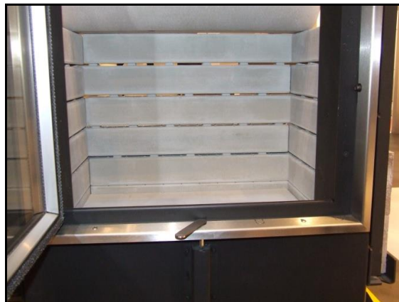
5.8 ábra: Ökotüztér, elosztott égéslevegő bevezetéssel és dupla üvegű ajtóval
