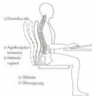
76. ábra 76 Helyesen beállított szék, jó testtartás
