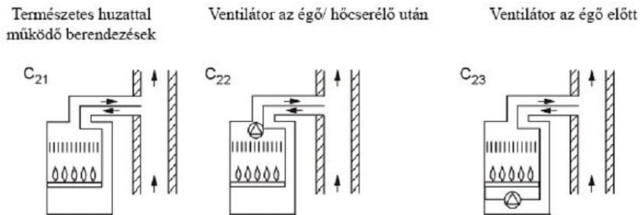
4.1.1/8. ábra: „C2” típusú készülékek.
