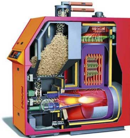
4.6/1. ábra Pellet tüzelésű kazán szerkezeti kialakítása
