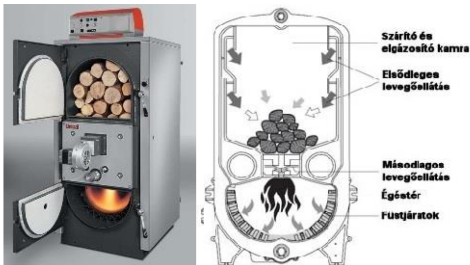
4.5/1. ábra: Faelgázosító kazán szerkezeti kialakítása.
