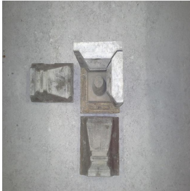
65. ábra műkö darabforma műkö maggal
