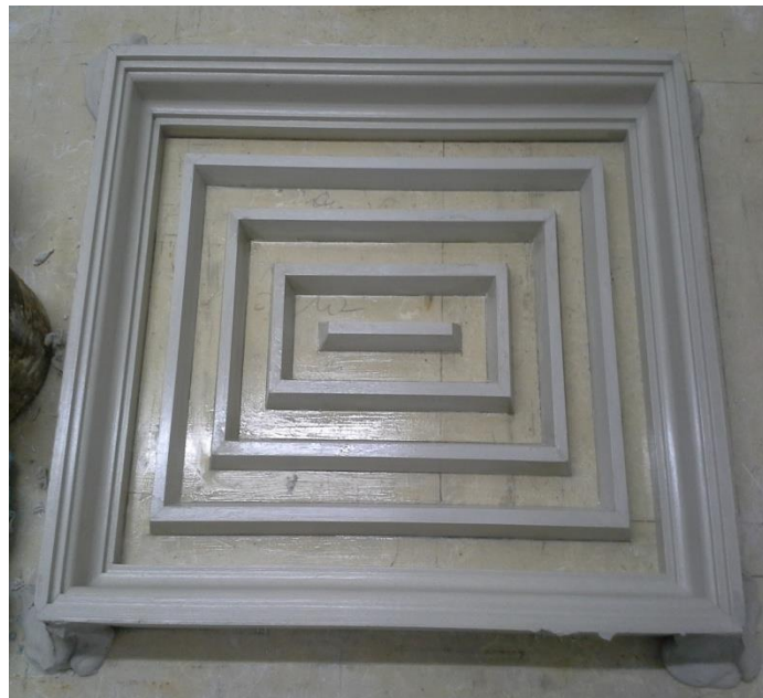
55.ábra terrazzó gipszformája beöntés előtti állapot
