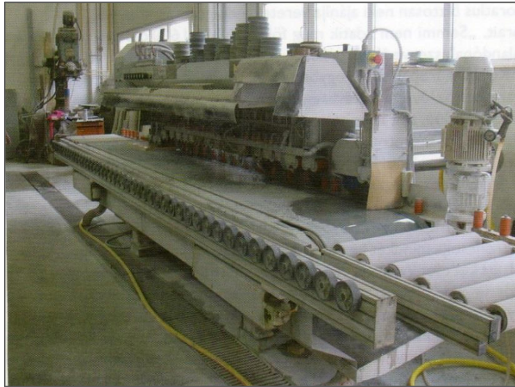
10.ábra Automata él csiszoló, nem csak egyenes él csiszolás, hanem profil, gömbölyítés gyártására is alkalmas
