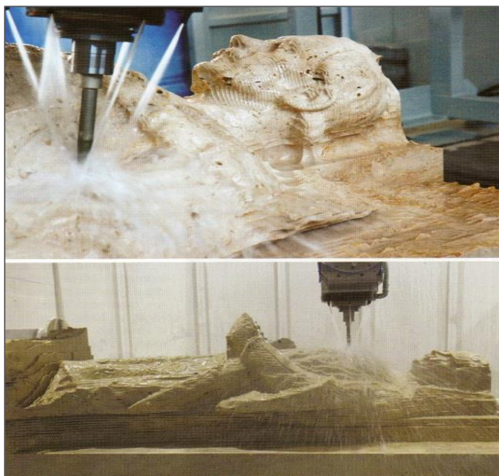
13. ábra Kőfaragó robotmaró munka közben
