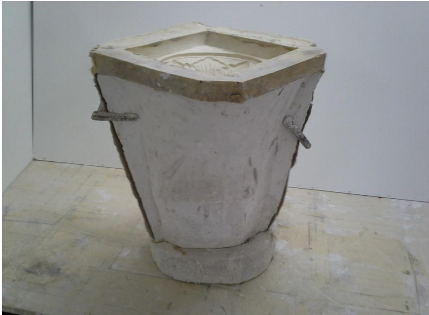
63. ábra gumidarabforma összeállítva és rögzítve
