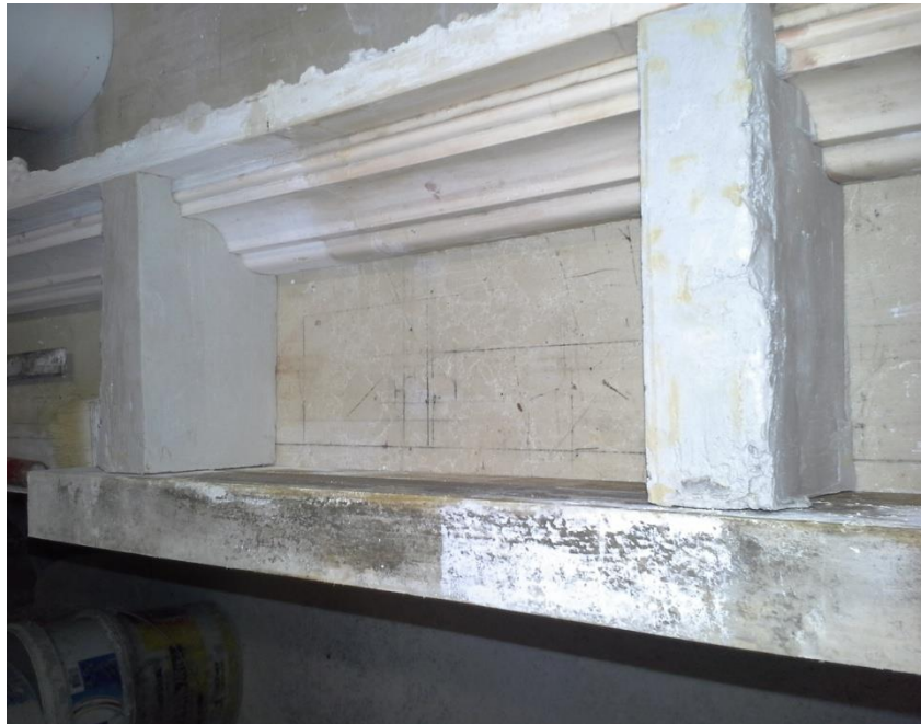
66. ábra vegyes forma profilos termék előállításához
