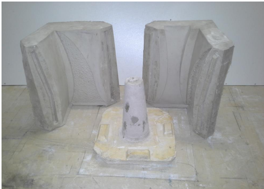
62. ábra gumidarabforma gipszmaggal
