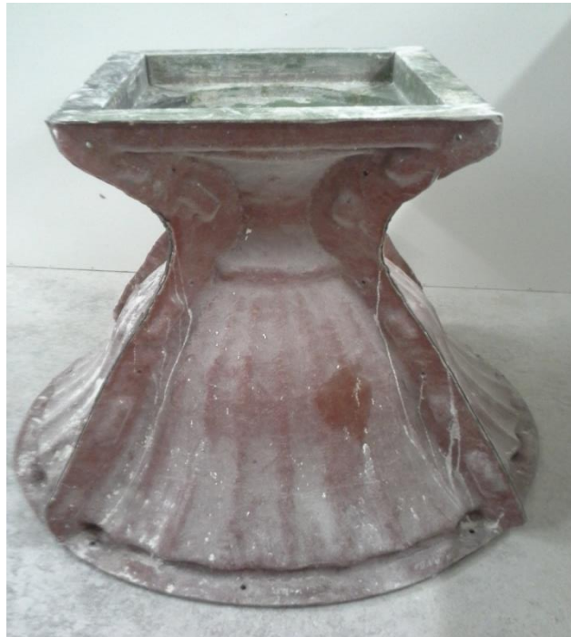
68.ábra műgyantaforma összeállítva, rögzítés csavarozással
