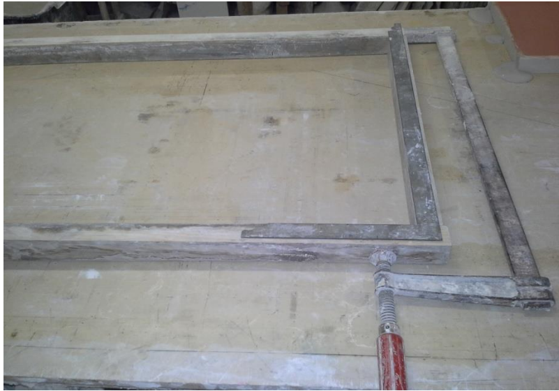
59.ábra fa keretforma és rögzítése
