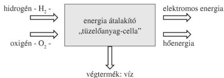
111. ábra. A tüzelőanyag-cella blokkvázlata
