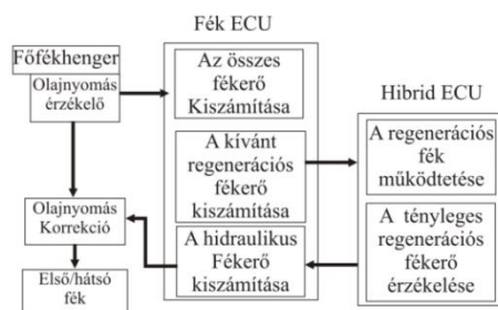
108. ábra. A fékrendszer blokkvázlata 122
