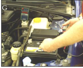
55. ábra. A fékfolyadék forráspontjának ellenőrzése 76
