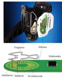
40. ábra. Gázpedálszenzor Forrás: Bosch 61
