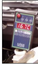
55. ábra. A fékfolyadék forráspontjának ellenőrzése 76
