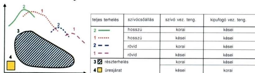
65. ábra. A harmadik generációs vezértengely-állító működése 88
