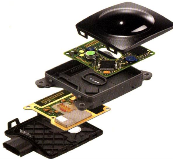
121. ábra. Az ACC rendszer radar érzékelője 134
