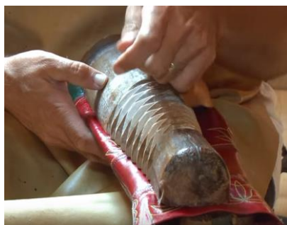
97. ábra: Felsőréssz sámfázása (1) 108
