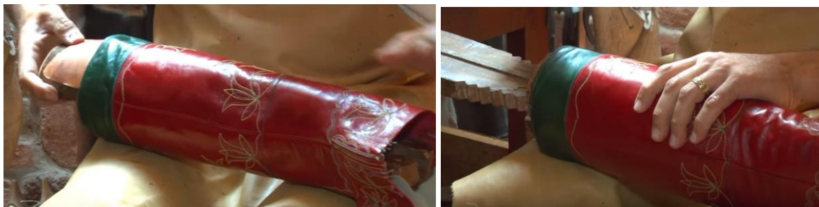
98. ábra: Felsőréssz sámfázása (2-3) 109
