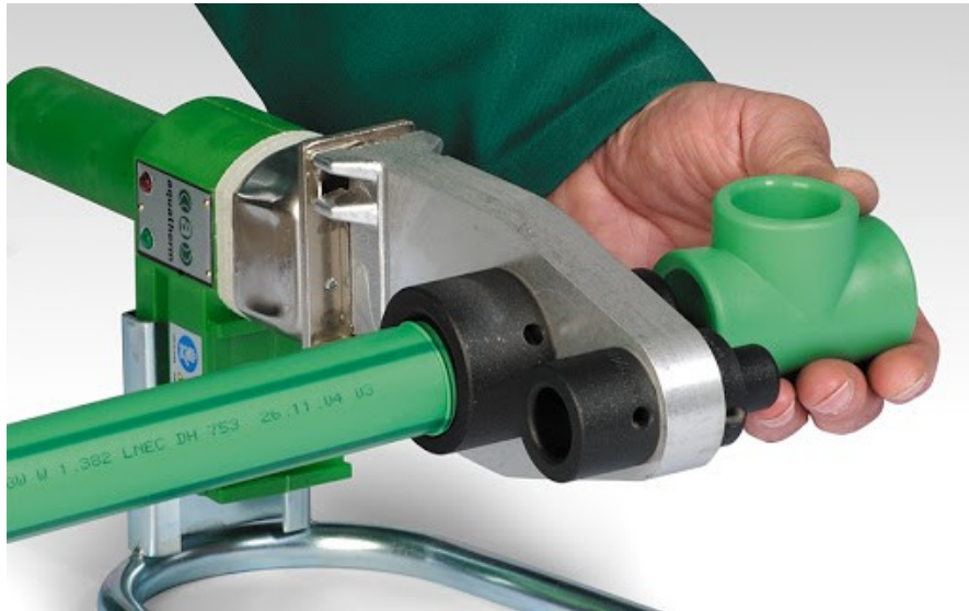
11. számú ábra kézi tokos hevítő elemes hegesztés
