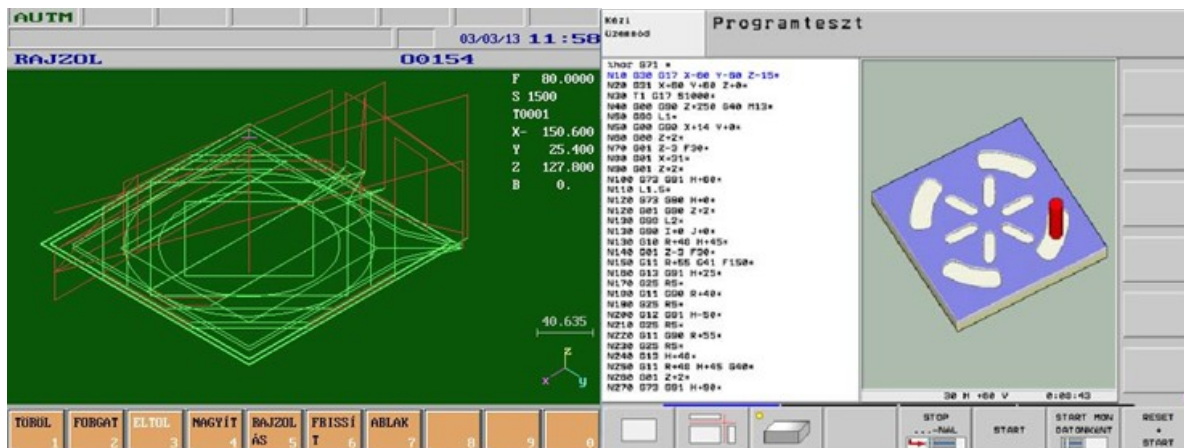
3.7.10. ábra: Két különböző vezérlés képernyőjén a programteszt üzemmód [4]
