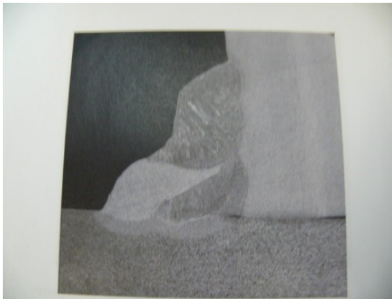
Ötvözetlen acél a gyök beolvadása nem megfelelő
