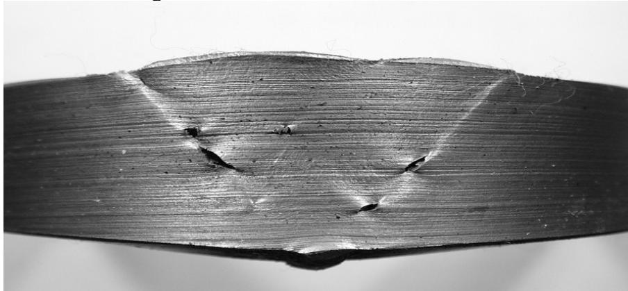
91. ábra: Hajlító vizsgálat 108
