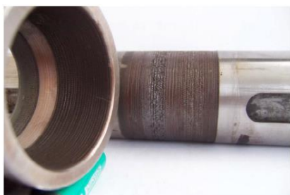
24. ábra Az oxidációs kopás (fretting) folyamata (súrlódási folyamatot erős oxidáció kíséri) [1]
