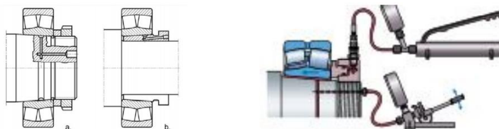
39. ábra Kúpos furatú csapágyak szerelése [3]
