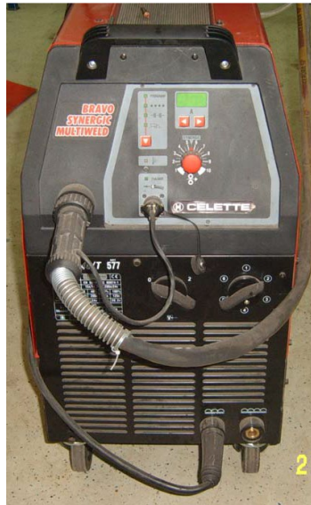
85 ábra: MIG forrasztásra alkalmas hegesztőgép
