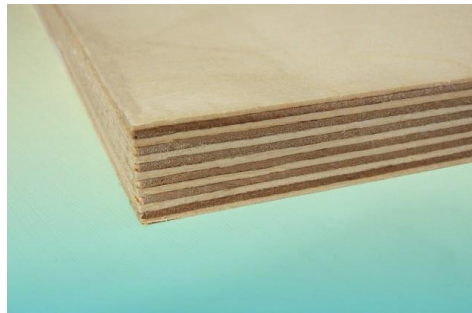
7. ábra Rétegelt lemez 7
