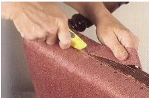
93. ábra Szegőszalag ragasztása szegezett élre 98
