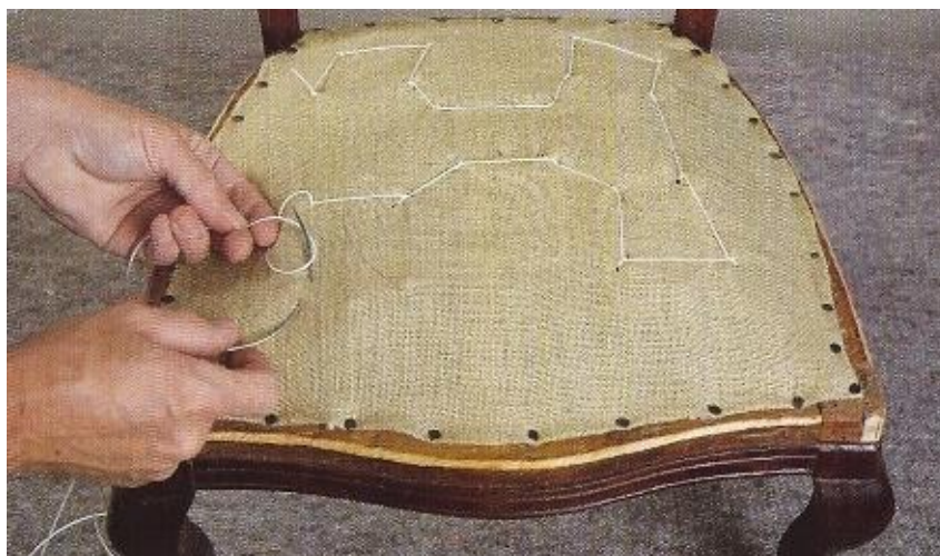
49. ábra Felületi varrás rugós alapon 48
