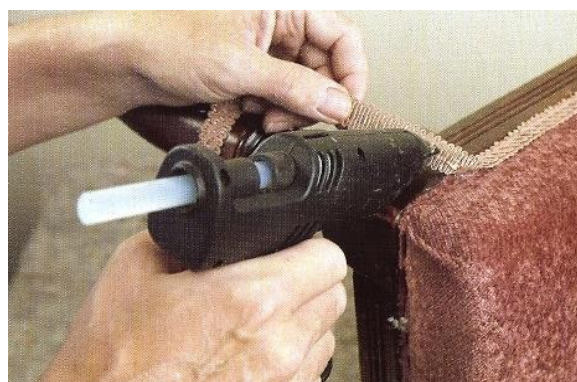
93. ábra Szegőszalag ragasztása szegezett élre 98
