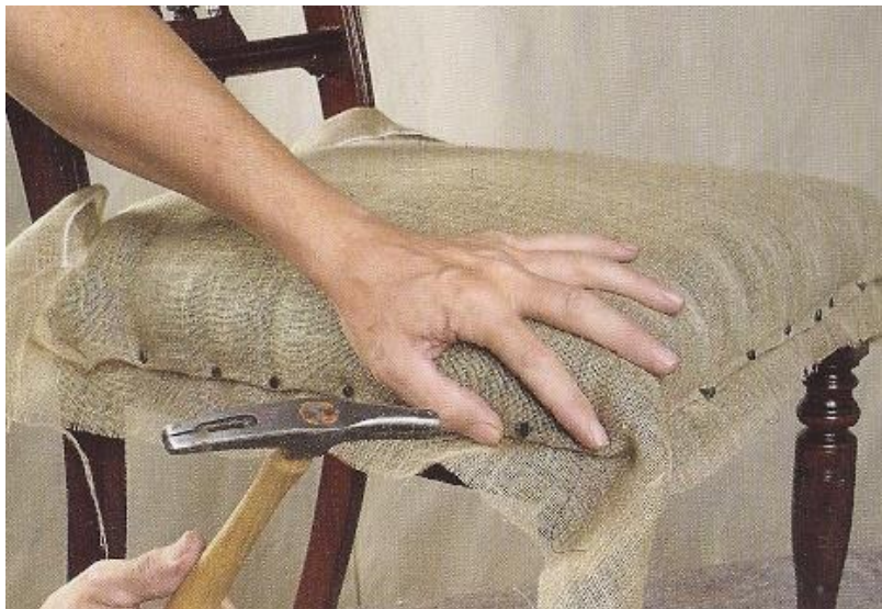
51. ábra Formavászon heftelése 50
