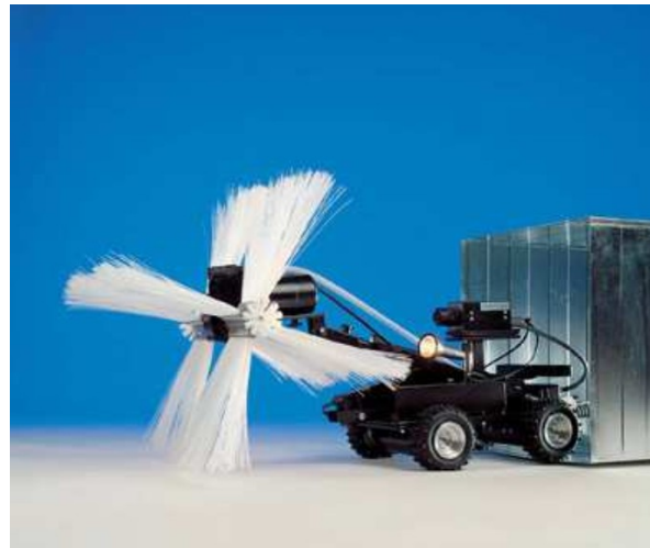
33. ábra 57 Robotra szerelt tisztítófej, négyzetes vízszintes légcsatornához.
