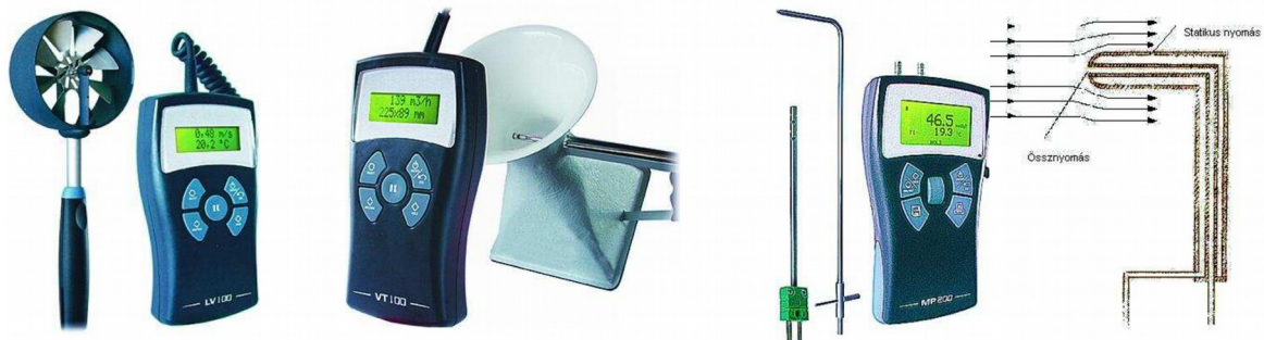
35. ábra 61 Szárnykerekű anemométer (szélsebességmérő), hődrótos anemométer, Pitot-cső, Prandtl cső.
