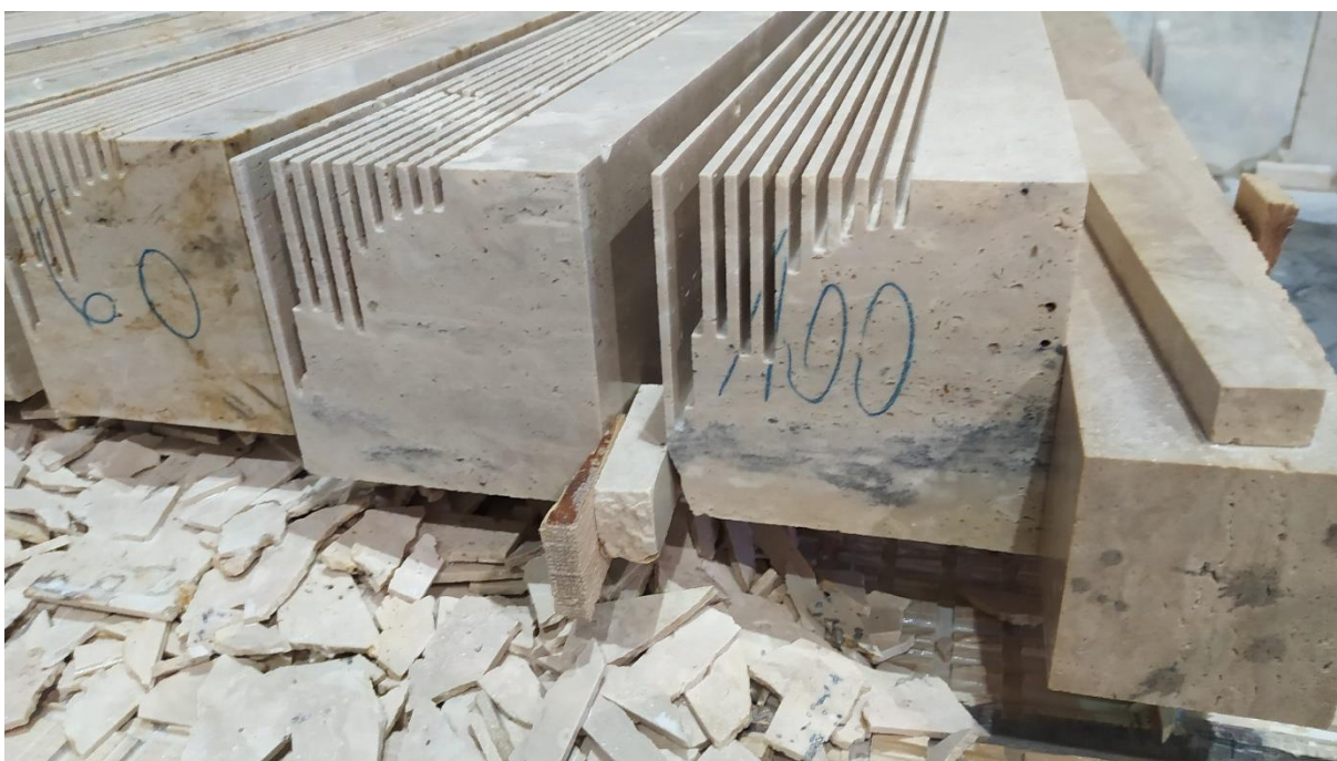
19.ábra kézi és gépi kőfaragáshoz előkészített kötőb
