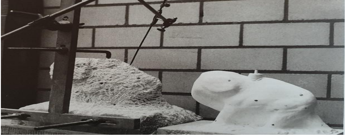
24.ábra pontozógép gipszmintával
