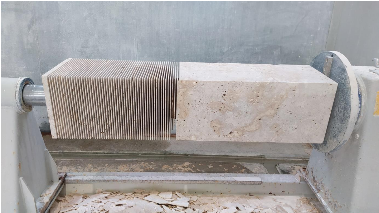
13.ábra CNC vezérelt géppel esztergálásra előkészített kő
