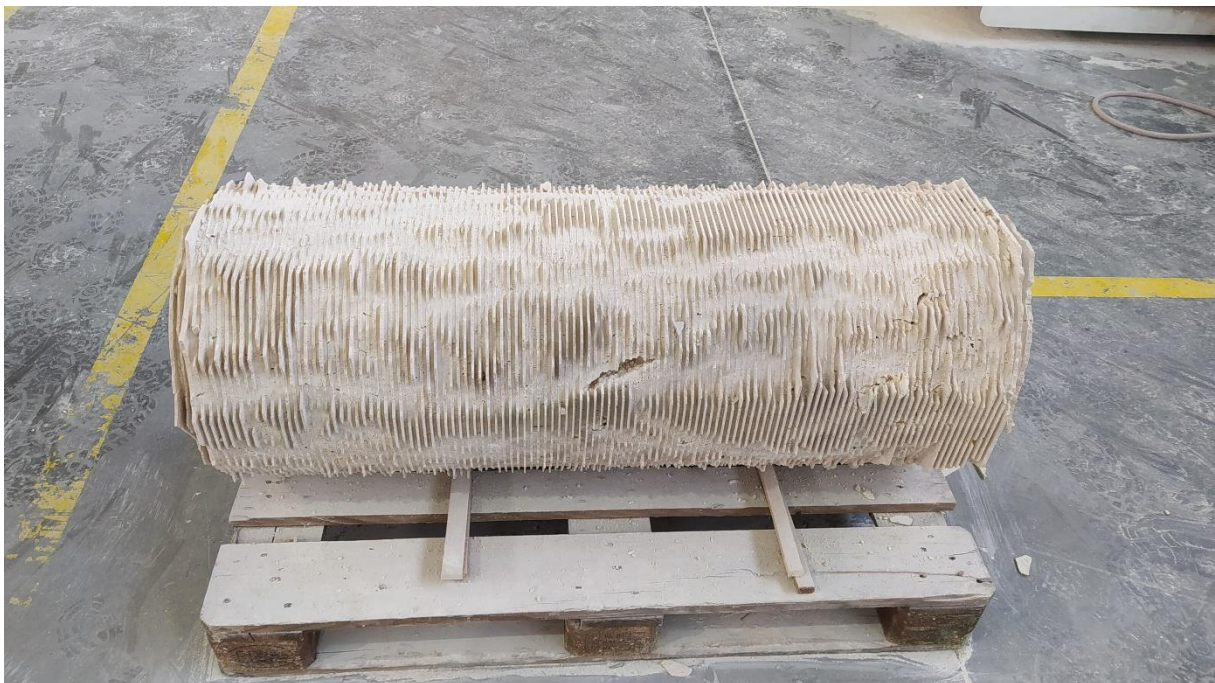
14.ábra CNC vezérelt géppel esztergálásra vagy kézi faragásra előkészített kő
