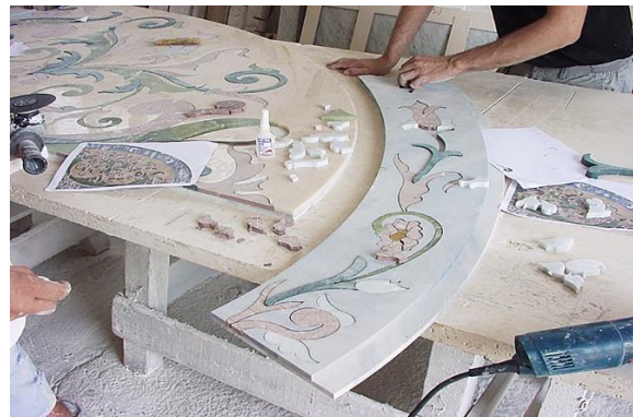
36. ábra berakásos kőpadló elemeinek elkészítése
