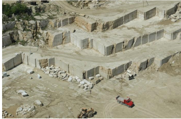
4. ábra tömbösített kövek kitermelése
