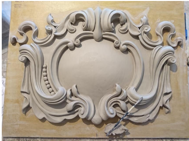
22. ábra elkészült minta, ami gipszbe önthető
