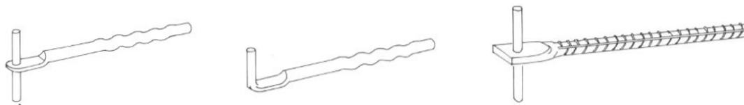
30. ábra. Rozsdamentes konzolok kőlap burkolatok homlokzati kapcsolásához fali furatokba, vésett fészkekbe habarcsolva.
