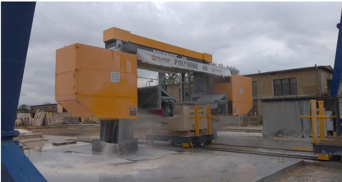
6.ábra Gyémánt drótvágó tömbök darabolására
