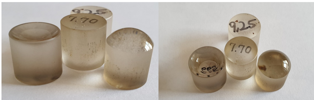
52. ábra. Üveg présfelszínek a PPMA lencsék készítéséhez, a görbületi sugár feltüntetésével. Stockinger-Bakonyi György saját fotó.
