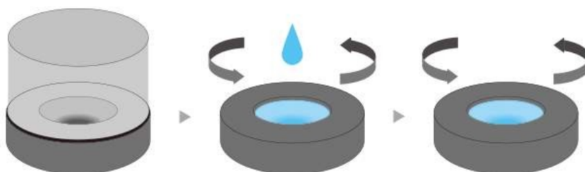
56. ábra. Kontaktlencse centrifugális öntése (spincast). 52
