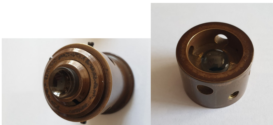
53. ábra. Présfelszínek a prészszerződésben PMMA lencsék készítéséhez. Stockinger-Bakonyi György saját fotó.
