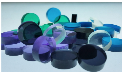
54. ábra. RGP kontaktlencse blankok. Ezekből esztergályozásos eljárással készülnek a gázáteresztő (RGP) kontaktlencsék. 50
