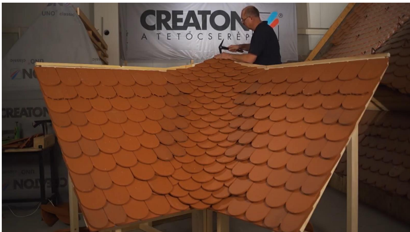
Két cserép széles német vápa végső fedésiképe kettősfedés esetében.
