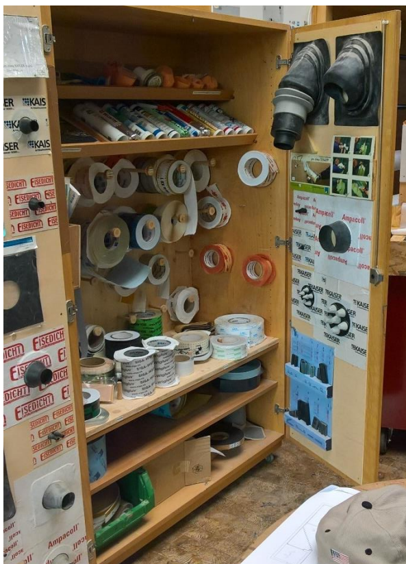
A légtömörégi sík kialakításának lehetséges kiegészítő elemei
